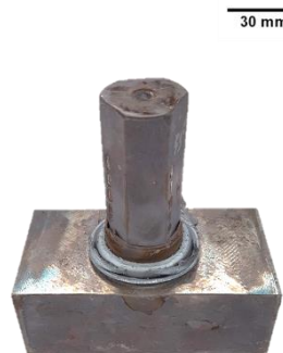
Figura 24: Amostra após o procedimento de soldagem e tratamento térmico.
