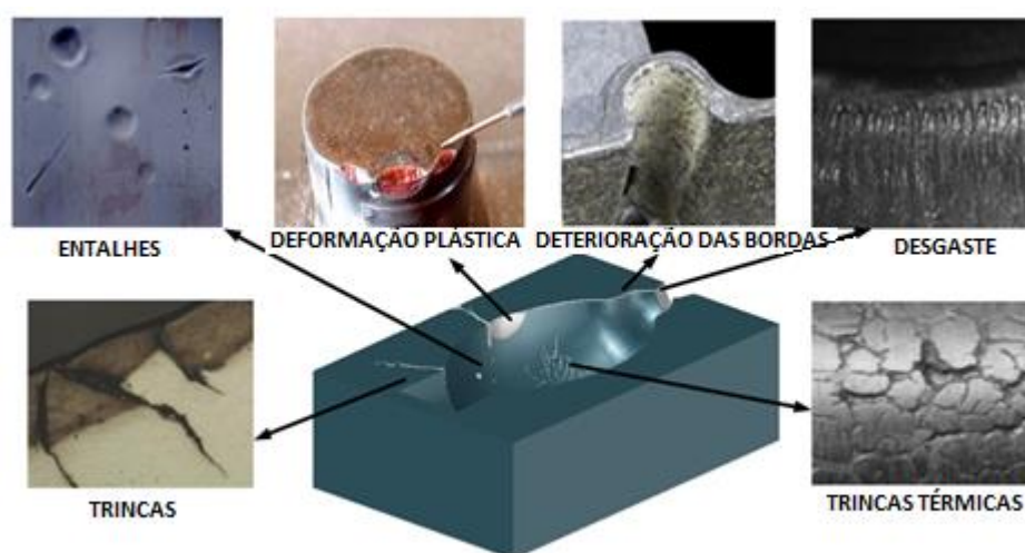
Figura 1: Principais tipos de defeitos em matrizes e moldes.
