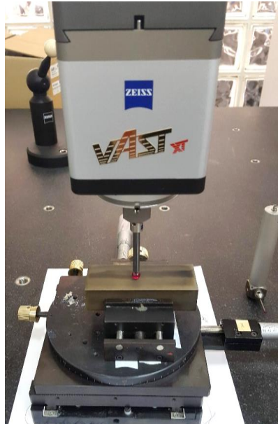
Figura 29: Medição dos deslocamentos oriundos do relaxamento de tensões nas superfícies dos blocos de base após o corte na máquina MMC.
