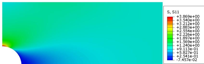
(b)  $\sigma_{11}$  - MEF.Figura 6.11 – Placa com furo: tensões  $\sigma_{11}$  pelo (a) MEC e (b) MEF.
