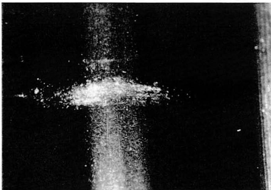
Figura 4.2.27. 03B03B - Pista externa LA, detalhe, mostrando pequeno encruamento da superfície, provavelmente em virtude das altas vibrações transmitidas desde o motor – 50 X.
