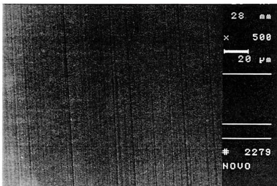
Figura 3.4.5. Rolamento SKF 6316 C3 novo sob MEV - 500 X.
