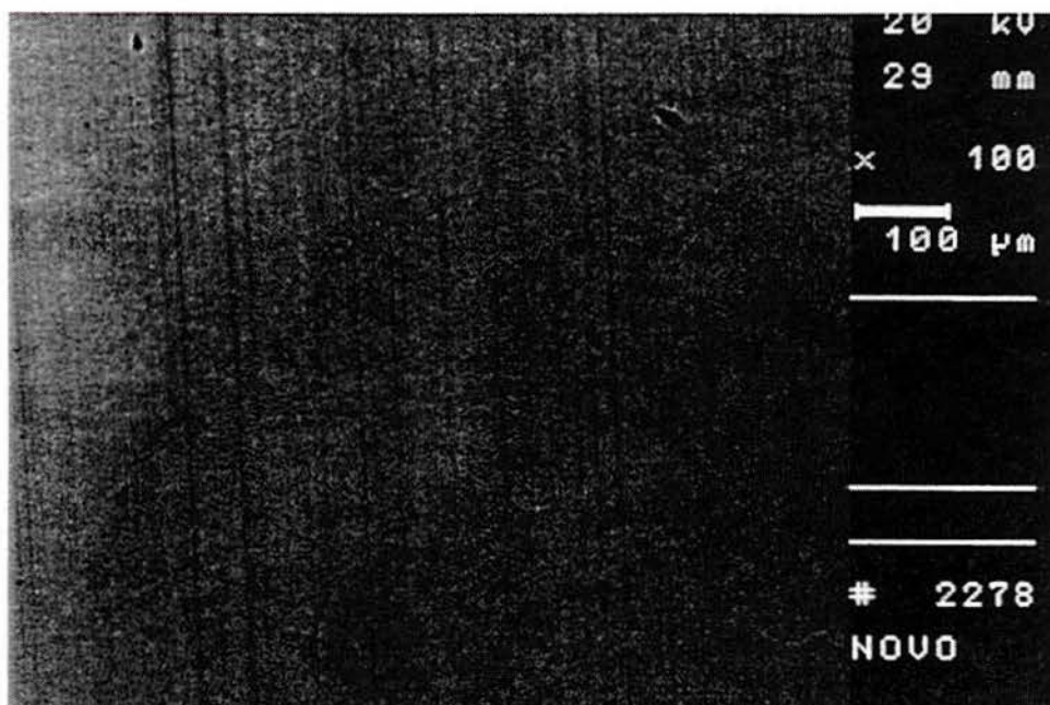
Figura 3.4.4. Rolamento SKF 6316 C3 novo sob MEV – 100 X.
