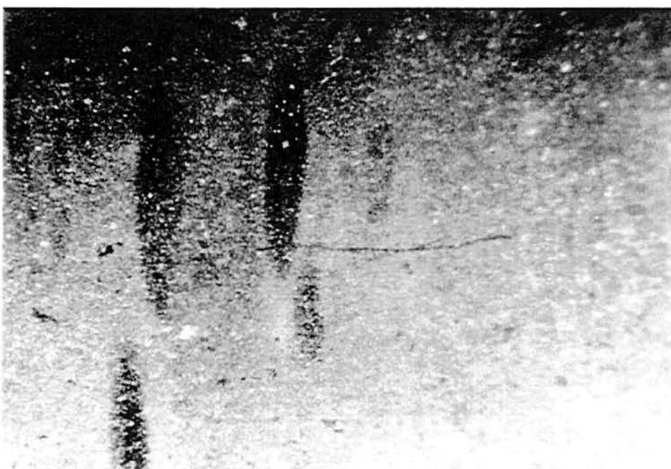
Figura 4.4.10. 13MB04A pista externa LOA – detalhe do encruamento ("brinelling").
