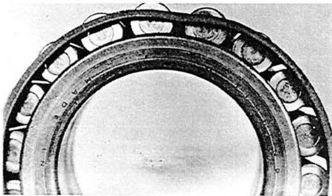
Figura 3.2.5. Gaiola separadora danificada.
