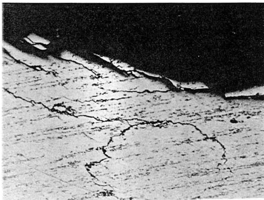
Figura 3.4.3. 34B01 - seção transversal da pista interna, com trincas em desenvolvimento.
