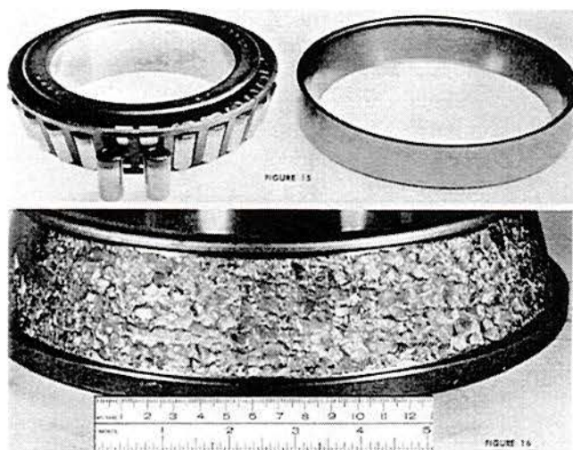
Figura 3.2.6. Dano por pré-carga axial excessiva.
