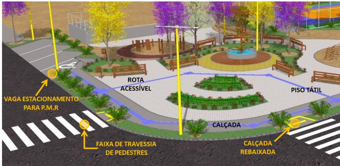
Figura 3 – Rota acessível em áreas comuns com piso tátil indicando o percurso a seguir
