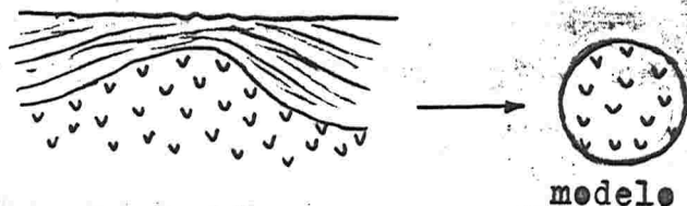
um corpo equidimensional de minério de alta susceptibilidade magnética, ou uma paleo-colina de embasamento cristalino coberta por sedimentos de baixa susceptibilidade magnética.
