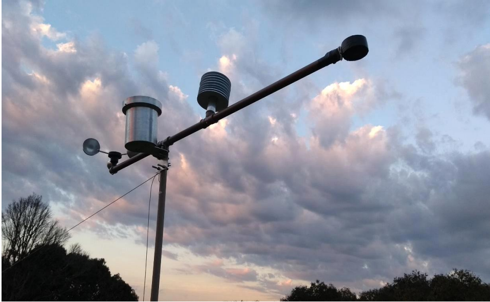
Figura 28: Sistema proposto (anemômetro, pluviômetro, radiação solar, temperatura do ar e umidade relativa do ar).
