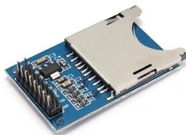
Figura 10 – Shield para cartão SD. Adaptado de Arduino,(2019).
