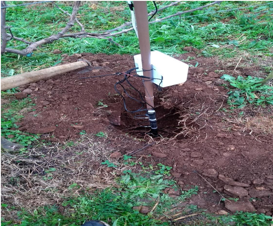
Figura 27: Sensores para cálculo do fluxo de calor no solo e caixa para armazenamento do micro controlador e do cartão de armazenamento
