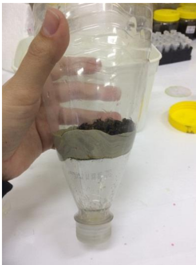
FIGURA 4. Garrafa para extração dos ácaros, laboratório de acarologia, UFRGS, Porto Alegre, RS, 2016. (Kênia Kerber, 2016).
