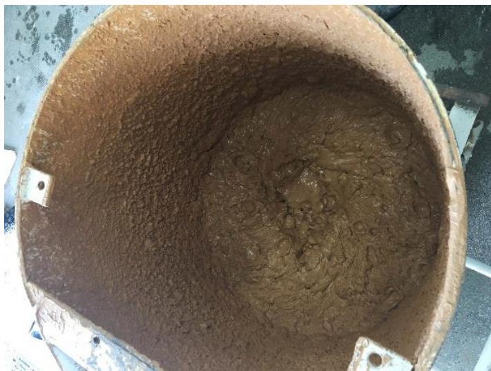
Figura 3.26 - Mistura argilosa após homogeneização no misturador.
