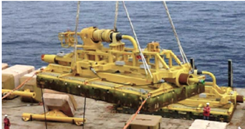
Figura 2.7 - Exemplo de PLET e sua fundação (GOURVENEZ e FENG, 2014).
