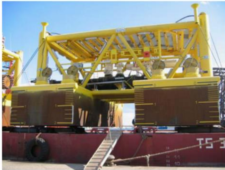
Figura 2.13 - Mudmats com saias como fundação para equipamento submarino (RANDOLPH et al. , 2011).
