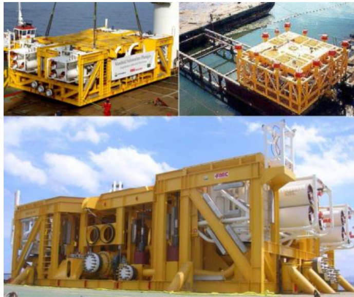
Figura 2.9 - Exemplos de Manifolds (FAGUNDES, 2010).
