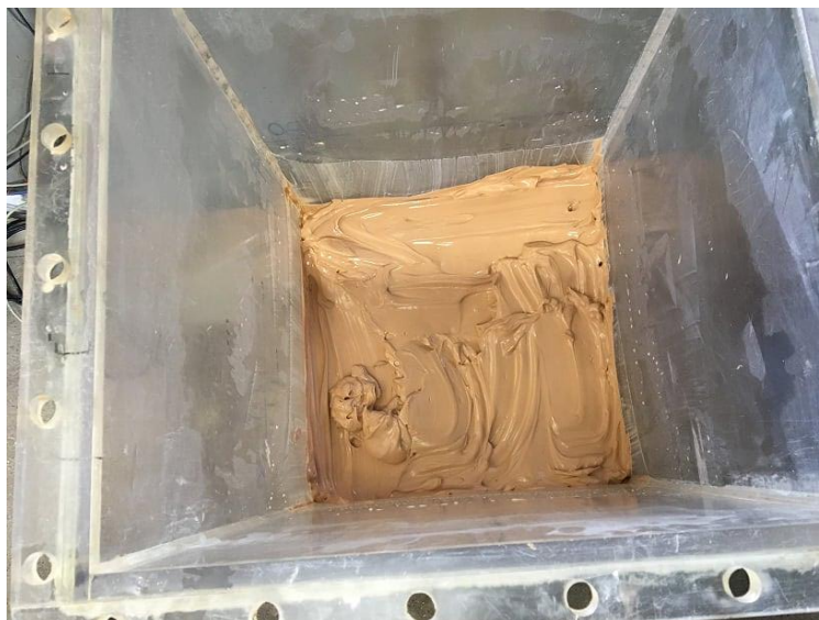
Figura 3.27 - Preenchimento do tanque de ensaio com a mistura argilosa.
