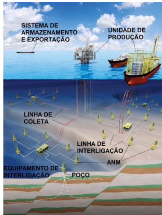
Figura 2.4 - Exemplo de arranjo submarino para exploração de petróleo (Cortesia Emerson Process Management apud LAI, 2009).
