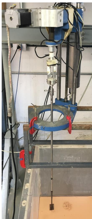
Figura 3.32 - Equipamento de mini-palheta posicionado sobre o tanque.
