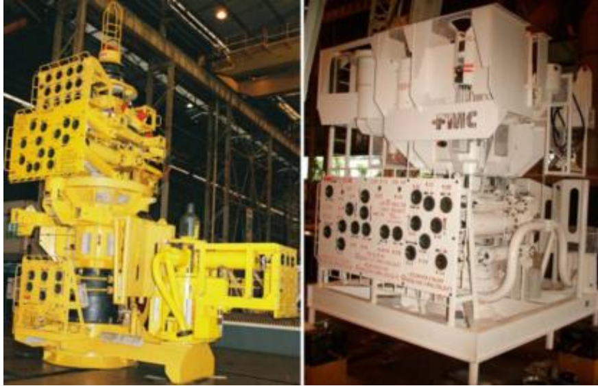
Figura 2.5 - Exemplos de ANMs: vertical e horizontal (Cortesia FMC Technologies apud LAI, 2009).
