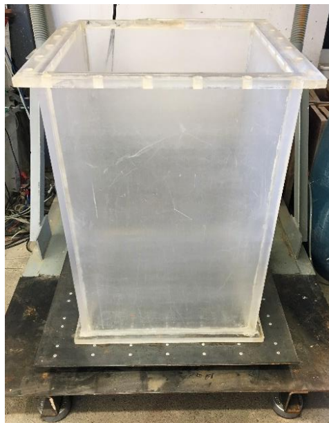
Figura 3.4 - Tanque de ensaio e base de aço para movimentação.
