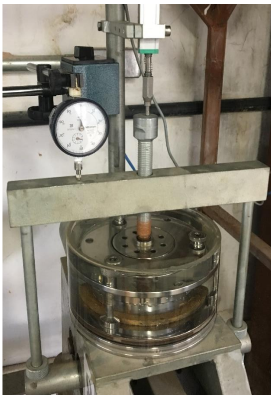
Figura 3.25 - Ensaio de adensamento em execução.
