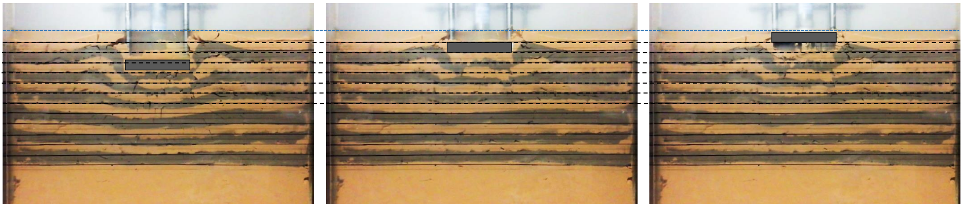
Figura 4.39 - Imagens dos ensaios de arrancamento após compressão com velocidade lenta (V5): (a) posição inicial; momento anterior ao rompimento; (c) após rompimento.
