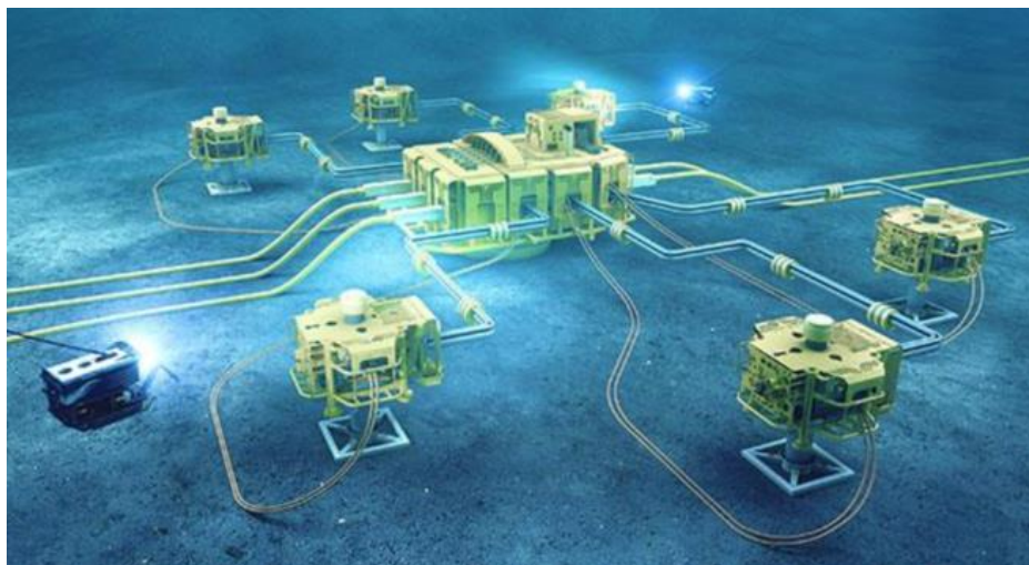
Figura 1.1 – Manifold em funcionamento conectado a seis poços de exploração (SILVA, 2015).
