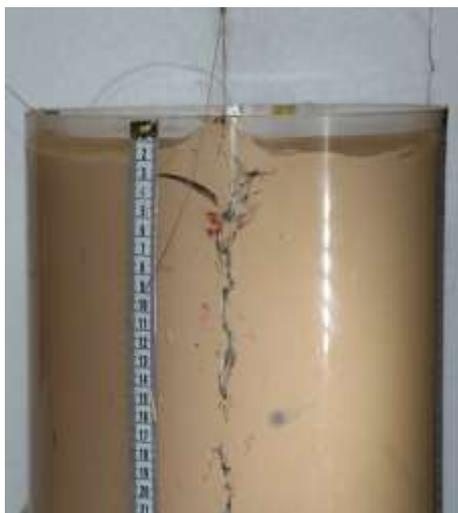
Figura 98 – Análise do mecanismo de interação e de ruptura em uma corrente de 4mm de diâmetro nominal.
