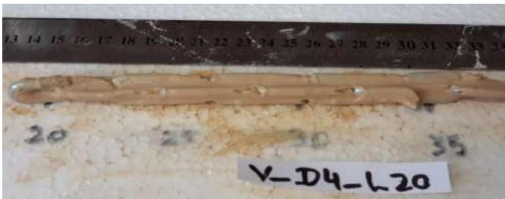
Figura 97 –Pesagem de uma corrente com solo depois da realização do ensaio de deslocamento vertical com corrente de 20cm de comprimento e 4mm de diâmetro nominal.
