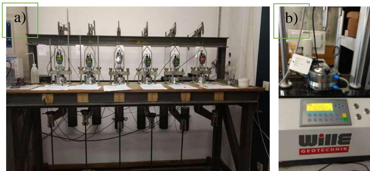
Figura 212 – a) Prensa de adensamento com tensão constante; b) Prensa de adensamento com taxa de deformação controlada
