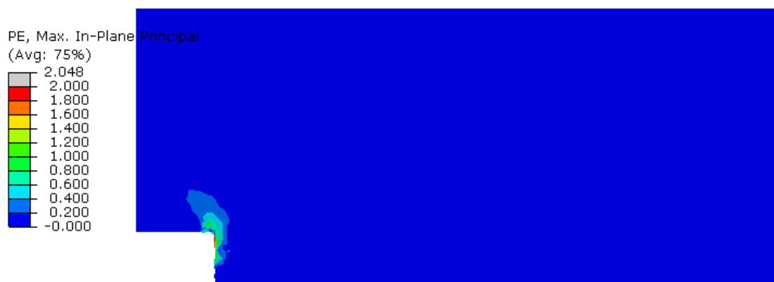
Figura 206 – Zona de plastificação no plano principal em pequenos níveis de deslocamento do tubo.
