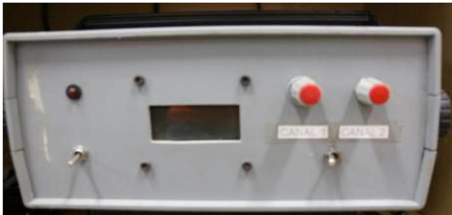
Figura 51 – Amplificador dos LVDT's.
