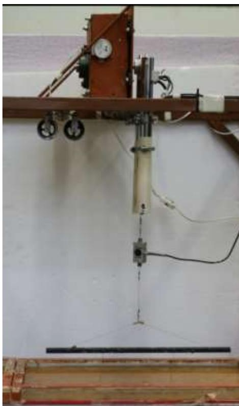
Figura 66 – Visão geral do esquema utilizado nos ensaios de deslocamento vertical no sentido transversal ao comprimento.
