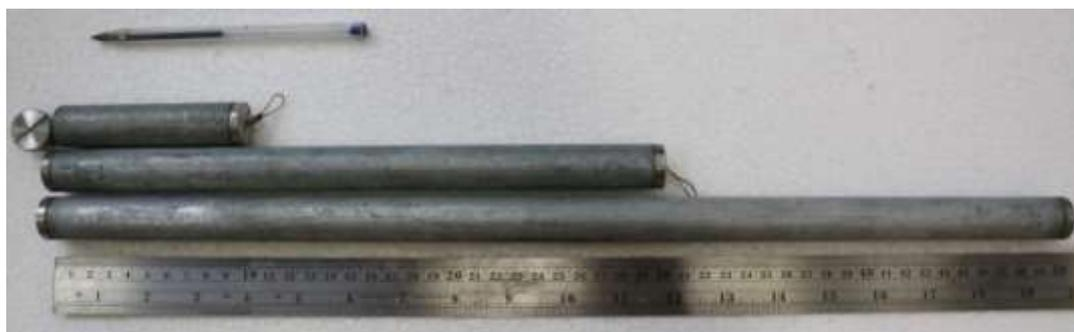
Figura 56 – Tubos metálicos de 10, 30 e 50cm de comprimentos.
