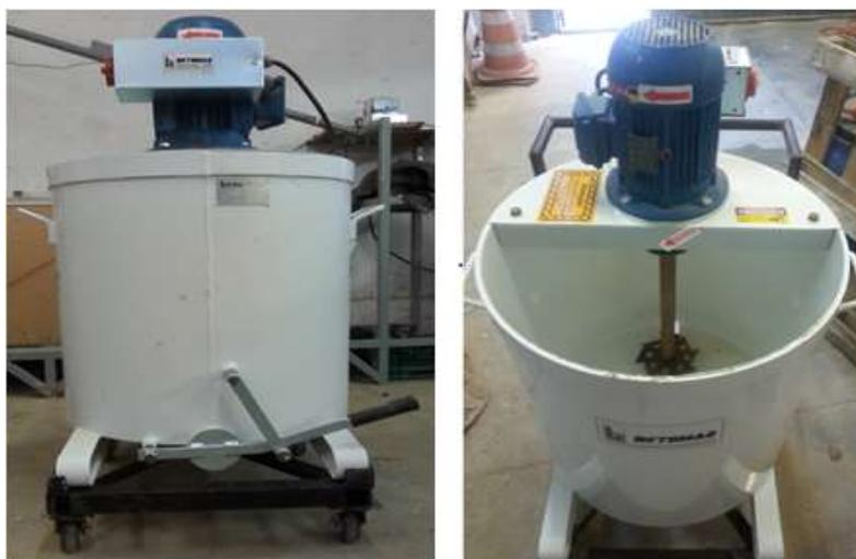
Figura 46 – Vistas lateral e superior do conjunto (misturador, bomba e carrinho) (SAMPA, 2015).
