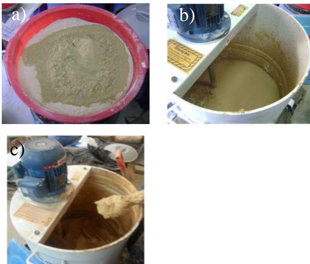
Figura 61 – Sequência de etapas durante a preparação das amostras: a) mistura à seco dos materiais b) mistura dos materiais no misturador c) retirada dos materiais do misturador para dentro do tanque.
