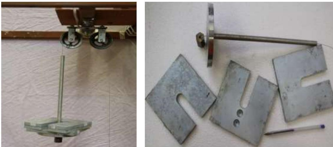
Figura 59 – Sistema para tracionamento de correntes.
