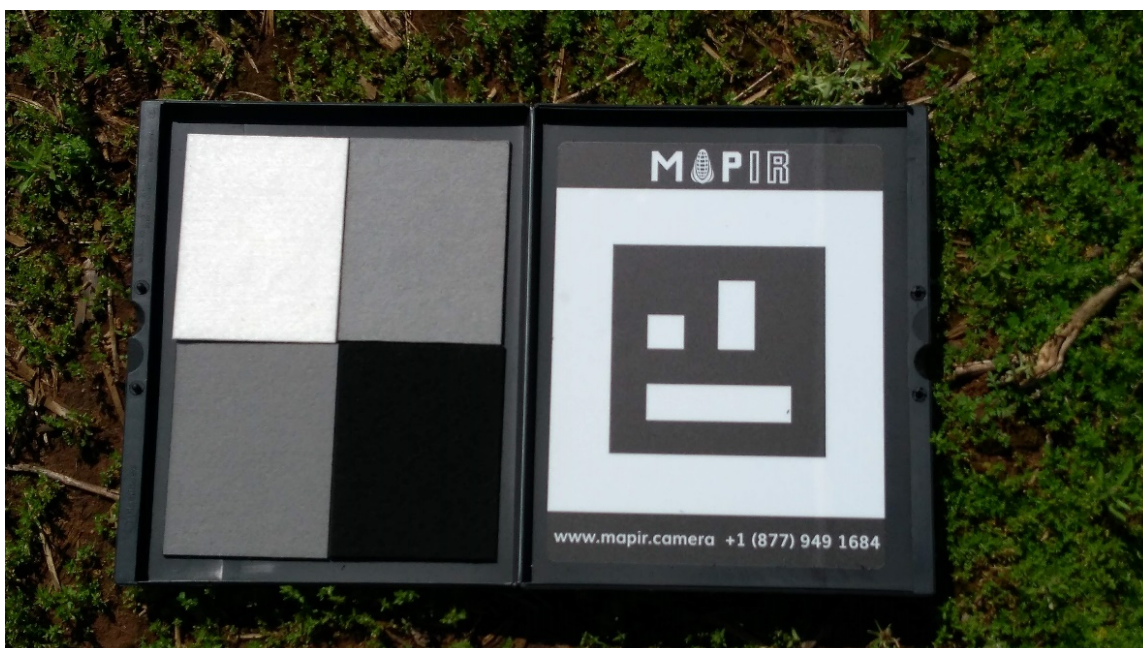
Figura 5 – Painel de calibração de reflectância Mapir V2 usado neste estudo
