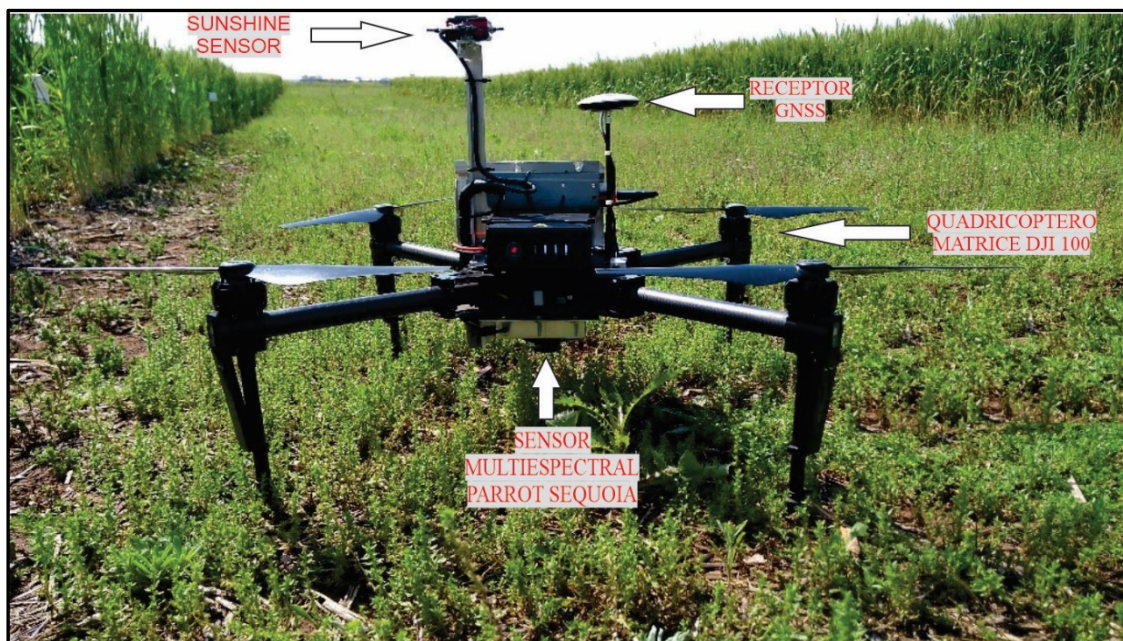
Figura 4- Quadricóptero Matrice 100 com sensor Parrot Sequoia.
