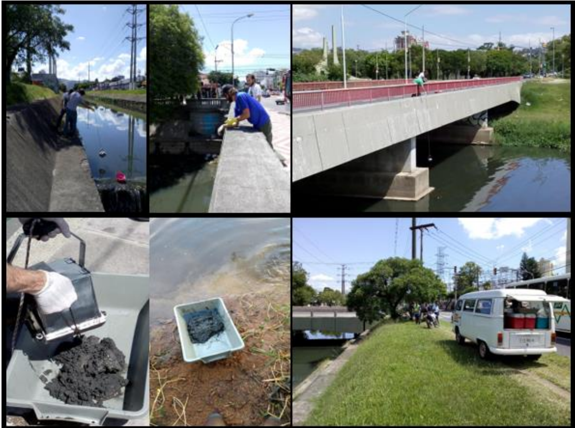
Figura 0.3: Procedimento de coleta das amostras de sedimentos com auxílio de uma draga modelos Eckman (2017).
