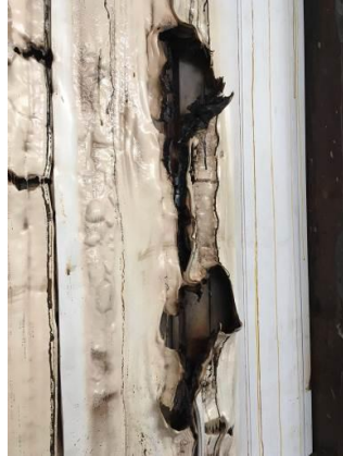
Figura 30 - Aspecto típico de fusão e deformações dos perfis de PVC testados
