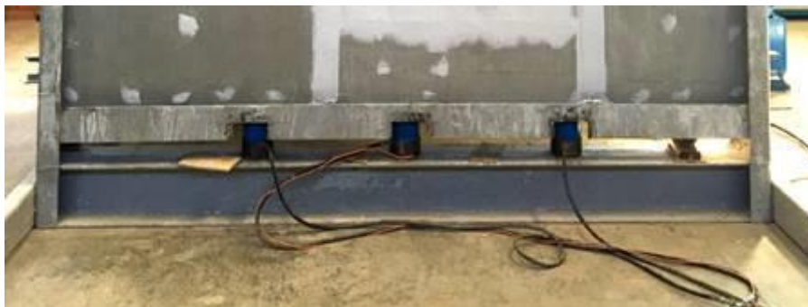
Figura 20 - Ilustração dos cilindros hidráulicos empregados para o carregamento
