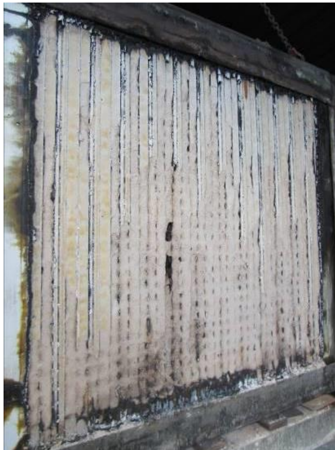
Figura 40 - Aspecto final da superfície da amostra exposta às elevadas temperaturas
