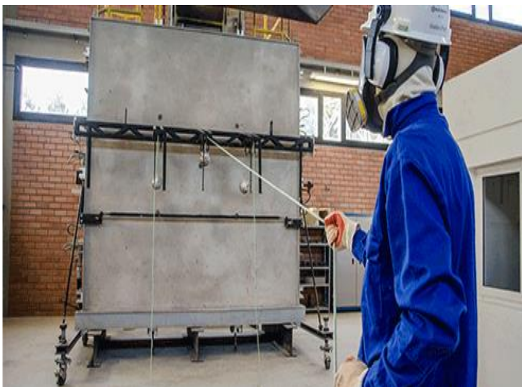
Figura 4 - Ilustração do procedimento do Ensaio de Resistência ao Fogo
