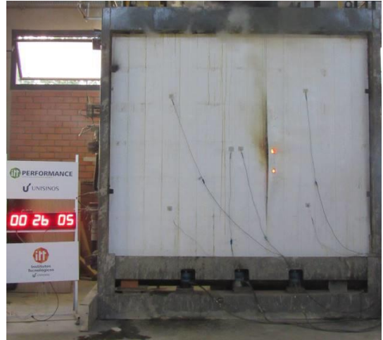
Figura 39 - Fissura deflagrada no centro da amostra
