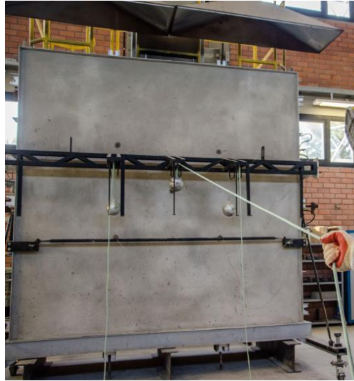
Figura 19 - Ilustração do teste de choque mecânico
