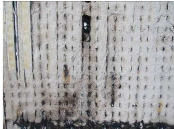
Figura 37 - Aspecto da face exposta às elevadas temperaturas (A) antes, e (B) após o ensaio
