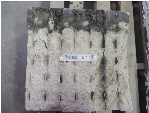
Figura 37 - Aspecto da face exposta às elevadas temperaturas (A) antes, e (B) após o ensaio
