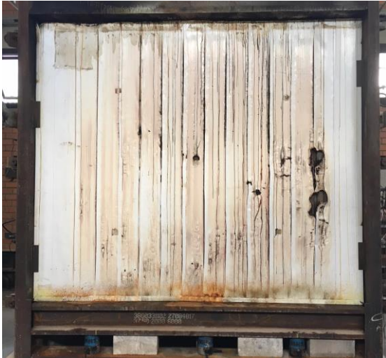
Figura 38 - Perspectiva final do sistema após o ensaio
