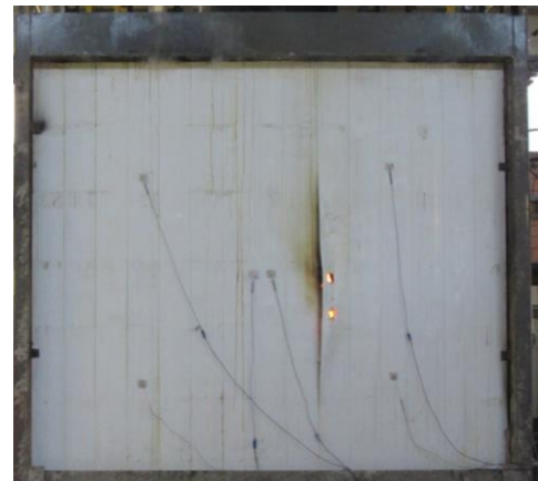
Figura 37 - Aspecto da face exposta às elevadas temperaturas (A) antes, e (B) após o ensaio
