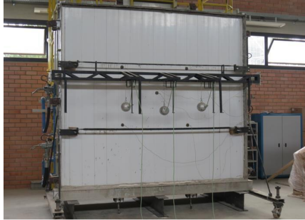
Figura 41 - Ilustração do teste de choque mecânico realizado à amostra
