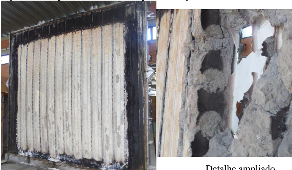
Figura 43 - Aspecto final da face exposta ao fogo da amostra
