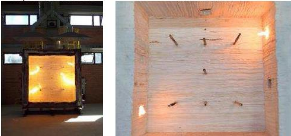
Figura 13 - Ilustração dos queimadores do forno empregado
