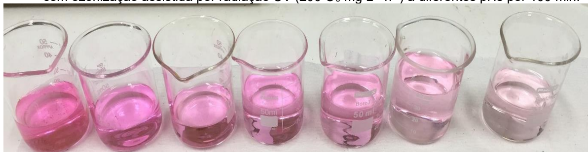
Figura 32 Degradação da cor de amostra de solução de RhB a 200 \text{ mg L}^{-1} em \text{H}_2\text{O} : AE (92:8% v/v), com ozonização assistida por radiação UV ( 200 \text{ O}_3 \text{ mg L}^{-1} \text{ h}^{-1} ) a diferentes pHs por 100 min.
