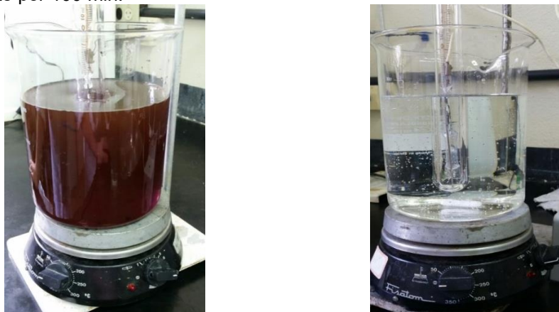
Figura 29. Aspecto do efluente simulado com 200 \text{ mg L}^{-1} de cada corante contendo a coloração de CV, RhB, LB e VB em solução aquosa com 8% de álcool etílico (v/v), e após tratado usando ZnO como catalisador sólido, na temperatura de 30 \text{ }^\circ\text{C} e pH 10 sob irradiação UV e agitação constante por 100 min.
