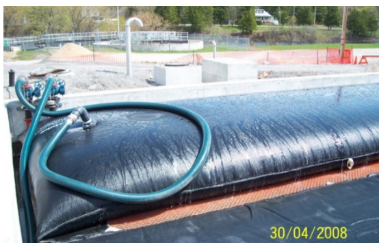
Figura 9. Bag de geotêxtil para desaguamento de lodo de tanque séptico em operação e durante a remoção do lodo desaguado após o fim do ciclo. Fonte: Drive e Polley (2010).
