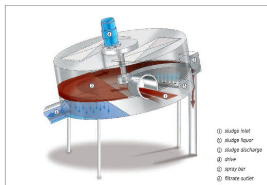
Figura 3. Adensador de lodo mecanizado. Fonte: Huber Technology [s.d.].
