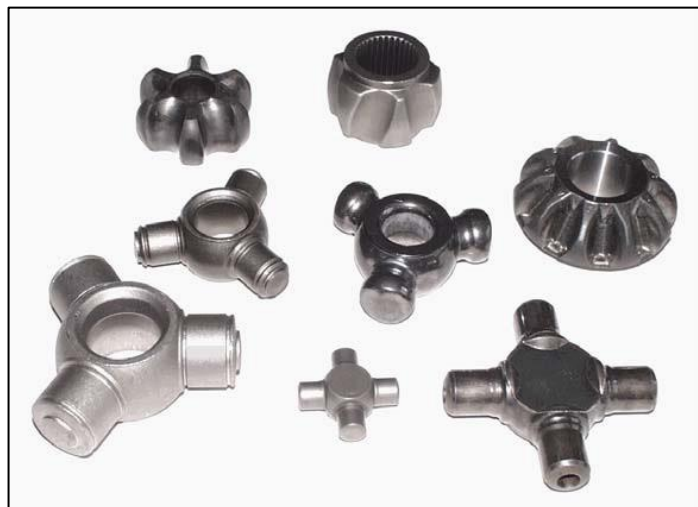
Figura 3 – Exemplos da variedade geométrica de peças metálicas produzidas por extrusão a frio [16].
