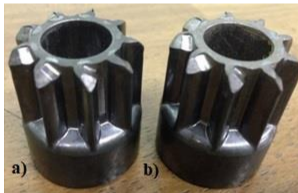
Figura 87 – Pinhões para motor de partida por extrusão a frio. a) Anéis convencionais b) Anéis STRECON
