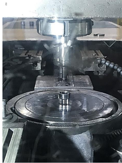
Figura 92 – Área de montagem da ferramenta na prensa excêntrica. Amostra de pinhão produzida.
