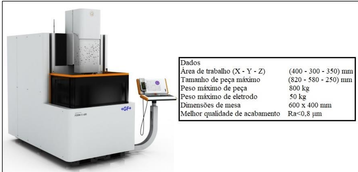
Figura 31 – Máquina de eletroerosão por penetração, modelo FORM X400 [67].
