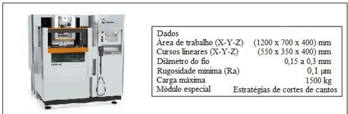
Figura 30 – Máquina de eletroerosão a fio, modelo CUT 300 mS [66].
