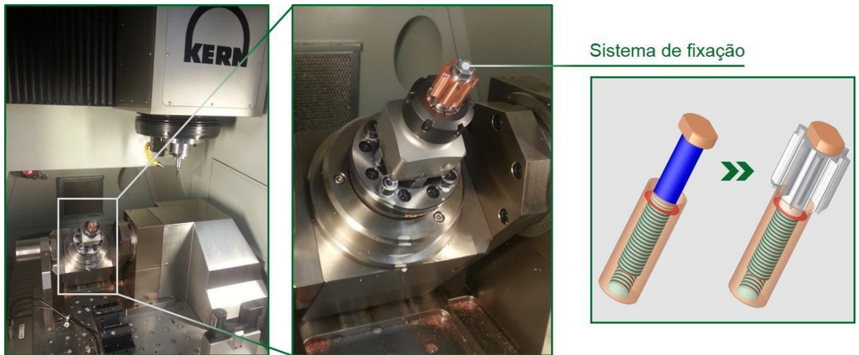
Figura 33 - Fixação do eletrodo no microfresamento.
