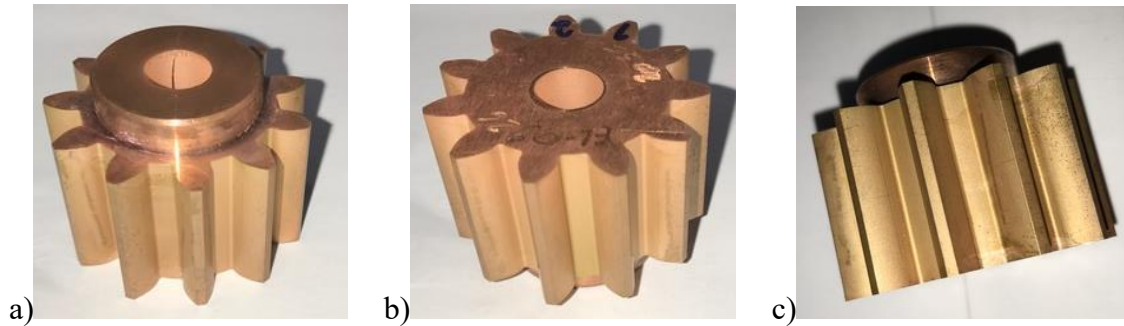
Figura 86 – Eletrodos resultantes do ensaio na máquina CUT 300 mS. a) Amostra 1. b) Amostra 2. c) Amostra 3.
