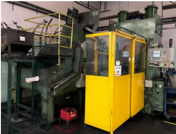
Figura 43 – Prensa mecânica MKN 450 A Komatsu com capacidade de força 450 toneladas.
