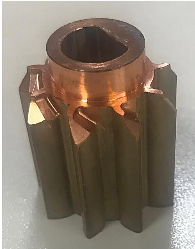
Figura 84 - Eletrodo resultante do ensaio na CUT 2000 S.
