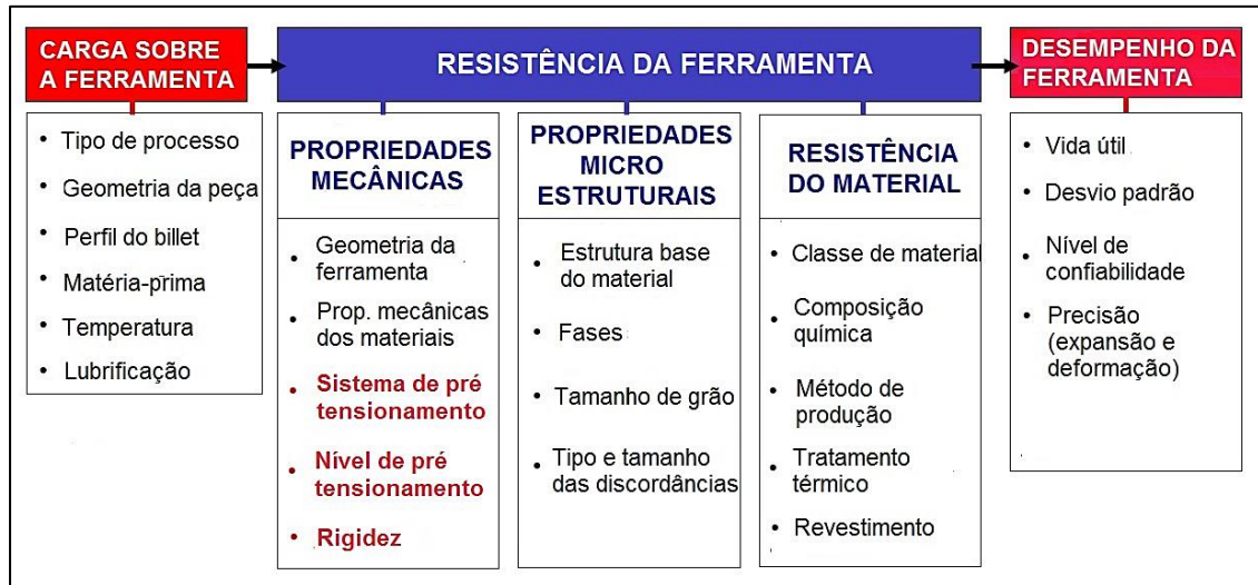
Figura 14 – Características relacionadas à resistência e desempenho de uma ferramenta de extrusão [16].
