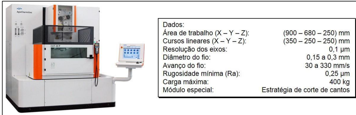
Figura 28 – Máquina de eletroerosão a fio, modelo CUT 20P [64].
