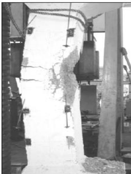
Figura 6.18 Fotografía de espécimen reforzado después del ensayo (KALIYAPERUMAL et al , 2009).
