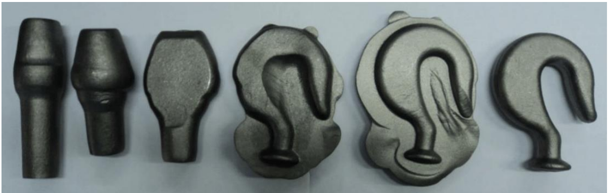
Figura 2. Geometrias conformadas em diferentes etapas de forjamento. (Balancin, 2015)
