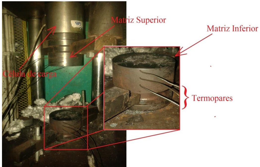
Figura 36. Matriz inferior instrumentada com termopares tipo K.
