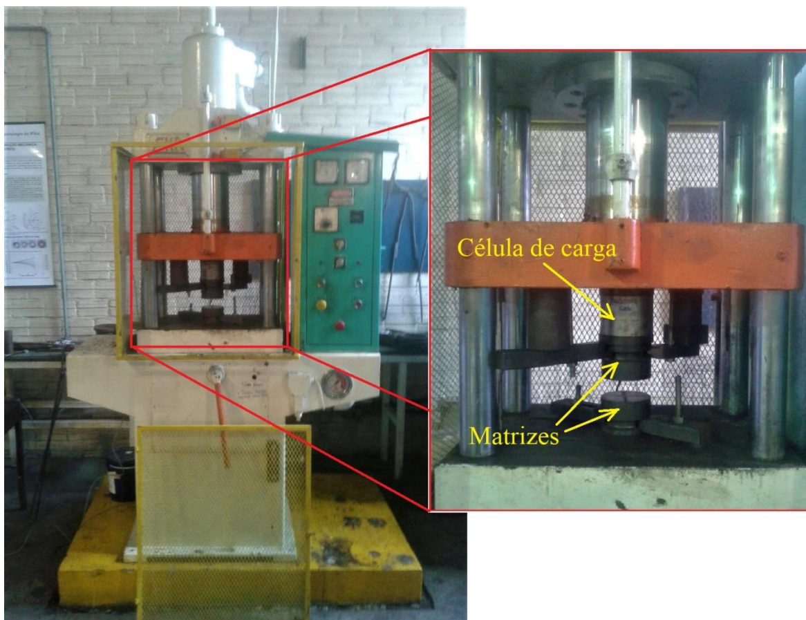
Figura 35. Prensa EKA utilizada nos experimentos de forjamento.
