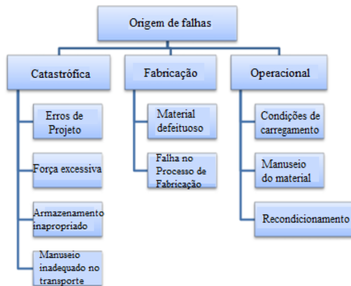
Figura 11. Classificação das causas de falhas em matrizes. Adaptado de (Chander, et al., 2016)
