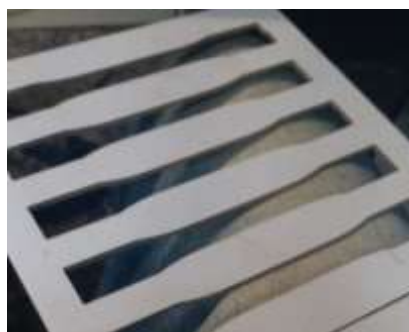
Figura 8. Molde dos corpos de prova.
