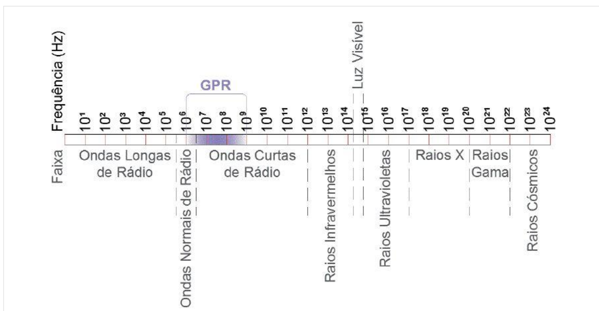
Figura 8: Espectro eletromagnético. Na figura é destacada a posição da frequência de operação do método geofísico do GPR, também empregado neste estudo. (Fonte: JARENTCHUCK JÚNIOR, 2013).
