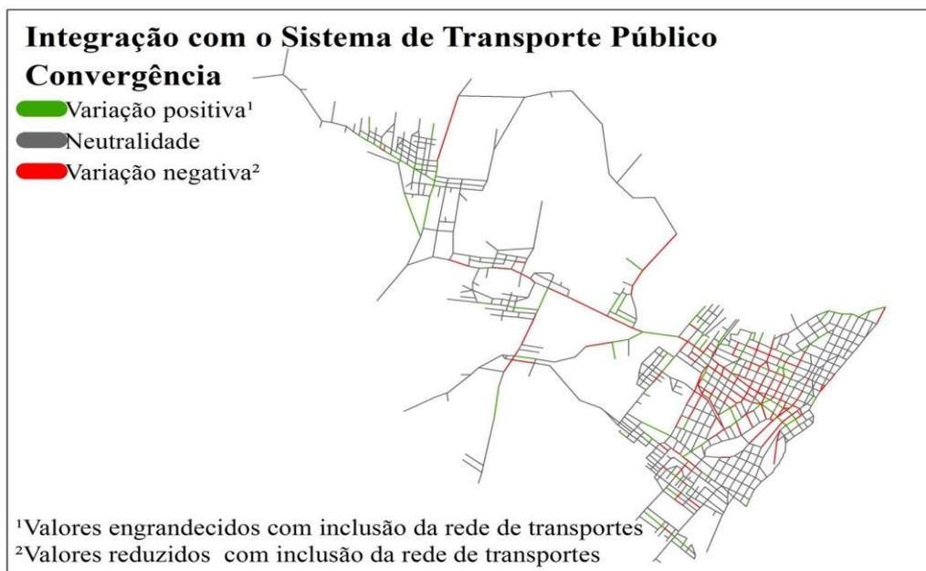
Figura 29 - Comparativo entre a medida de convergência quando aplicada com e sem a integração com o transporte público
