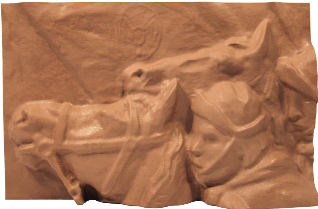
Figura 51 – Peça usinada finalizada, já com aplicação de selador.
