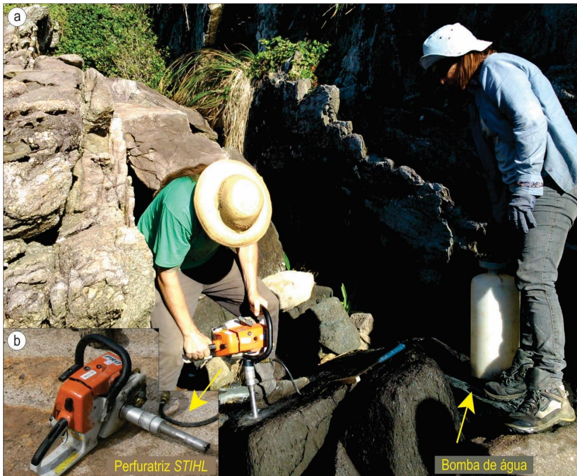
Figura 6. Procedimento de amostragem: a) perfuração realizada com uma perfuratriz portátil adaptada com broca diamantada e sistema de refrigeração (bomba com mistura de água e óleo solúvel) para diminuição do atrito durante a perfuração. b) Detalhe da perfuratriz utilizada com broca diamantada.
