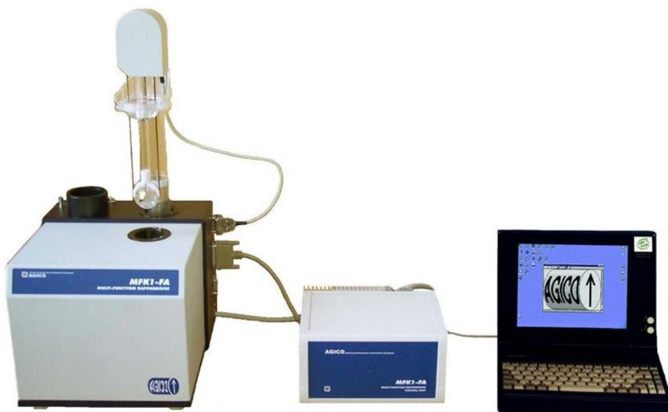
Figura 9. Susceptibilímetro Kappabridge MFK1-FA utilizado para a aquisição dos dados de ASM (extraído de AGICO Ltd., República Tcheca).
