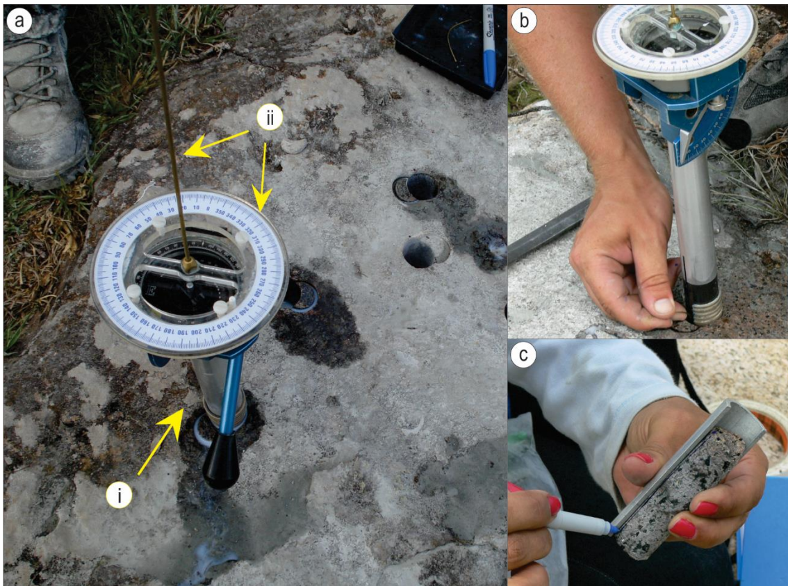
Figura 7. Procedimentos de orientação dos cilindros. a) orientador com haste cilíndrica de alumínio com ranhura na base (i) e bússola magnética acoplada no topo da haste cilíndrica, transferidor de 360° e haste de metal para fazer a leitura do azimute solar (ii); b) detalhe do clinômetro para medir a inclinação do furo; c) marcação do referencial geográfico no cilindro após sua orientação.
