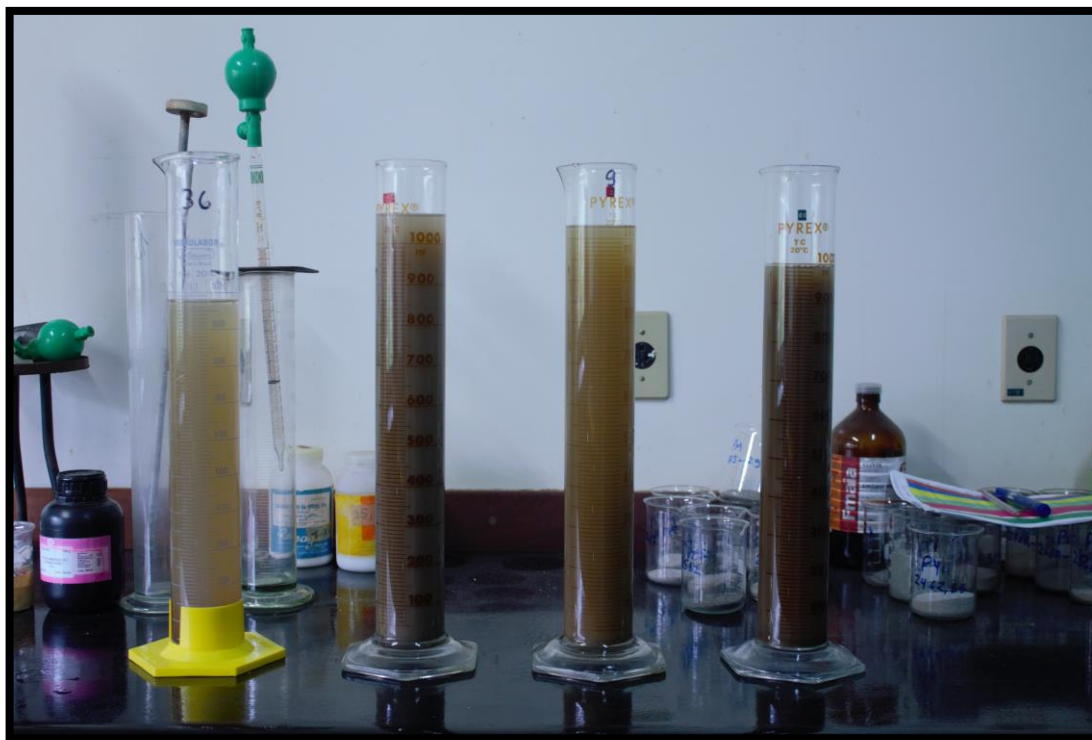
Figura 29: Preparação das amostras para análise granulométrica. Processo de decantação do silte e pipetagem da argila.
