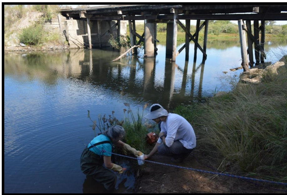
Figura 21: Coleta de amostra de sedimento de fundo no Ponto 2.
