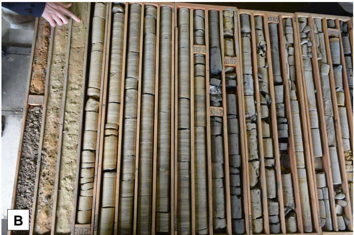
Figura 7: Em A, frente de lavra na Mina Candiota. Em B, testemunho de sondagem de Área da Mina Candiota, cedido pela Companhia Riograndense de Mineração (CRM).
