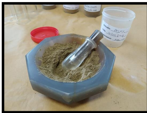
Figura 30: Amostra peneirada sendo desagregada utilizando gral e pistilo de ágata.
