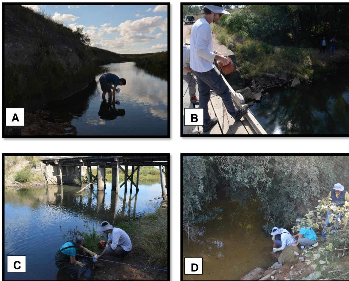
Figura 17: Em A, coleta de amostra no ponto branco utilizando pá. Em B, coleta de amostra utilizando Draga Van Veen. Em C, coleta de amostra utilizando macacão impermeável para entrar no arroio. Em D, coleta de amostra utilizando pá.
