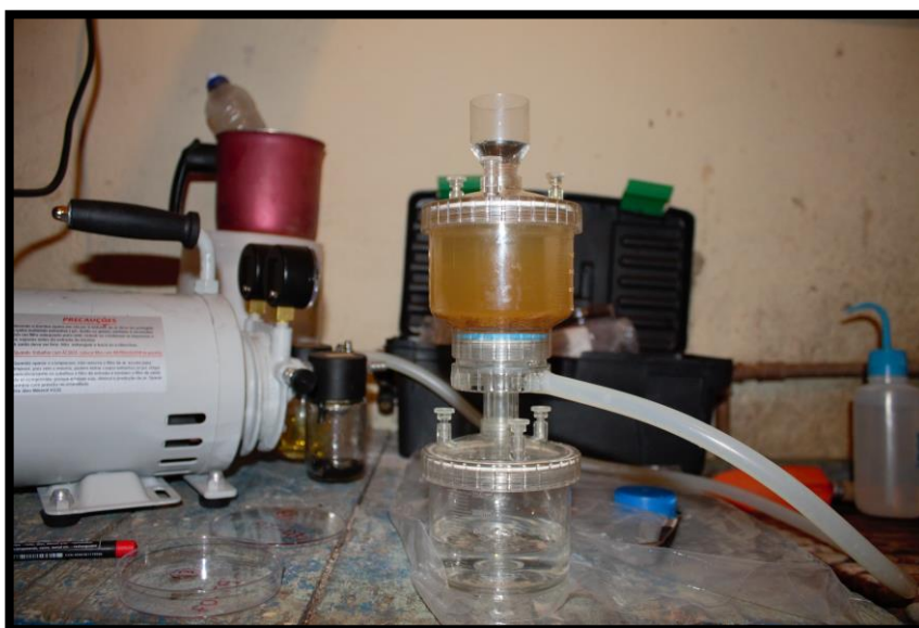
Figura 19: Procedimento de coleta de sedimento em suspensão e filtragem.
