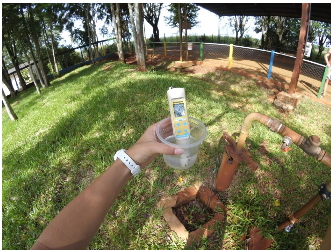
Figura 18 – Análise in situ realizada com a sonda multiparâmetros.
