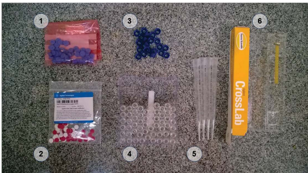
Figura 13. Foto mostrando os insumos essenciais para o Laboratório de Glacioquímica/Isótopos Estáveis do CPC. Os itens (1) e (2) correspondem a septos, sendo o primeiro utilizado pelo equipamento (na entrada do vaporizador) e o segundo utilizado na tampinha dos vials. Os itens (3) e (4) referem-se, respectivamente, as tampinhas de rosca e os vials limpos de vidro transparente. O (5) são as ponteiras da pipeta monocanal da Transferpette® S utilizada na pipetagem das amostras. O (6) é a seringa do autoamostrador do equipamento analítico.
