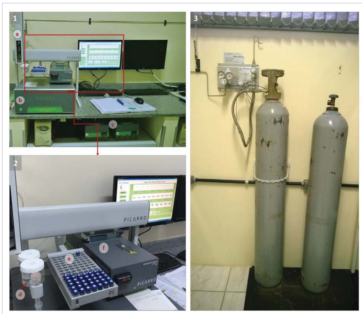
Figura 16. Fotos do Sistema PICARRO® L2130-i. (1) Foto geral do equipamento destacando alguns componentes do equipamento – (a) é o autoamostrador, (b) é o analisador e (c) são as bombas peristálticas. (2) Detalhe da área em vermelho – (d) são as estações de limpeza da seringa, (e) é a bandeja de amostras e (f) o vaporizador. (3) Foto do sistema de gás nitrogênio.
