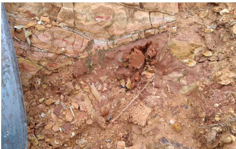
Figura 19: Foto amostra de rocha da área de empréstimo in situ . Silte bege em contato com a lente de argila rica em matéria orgânica e óxidos. (foto do autor).
