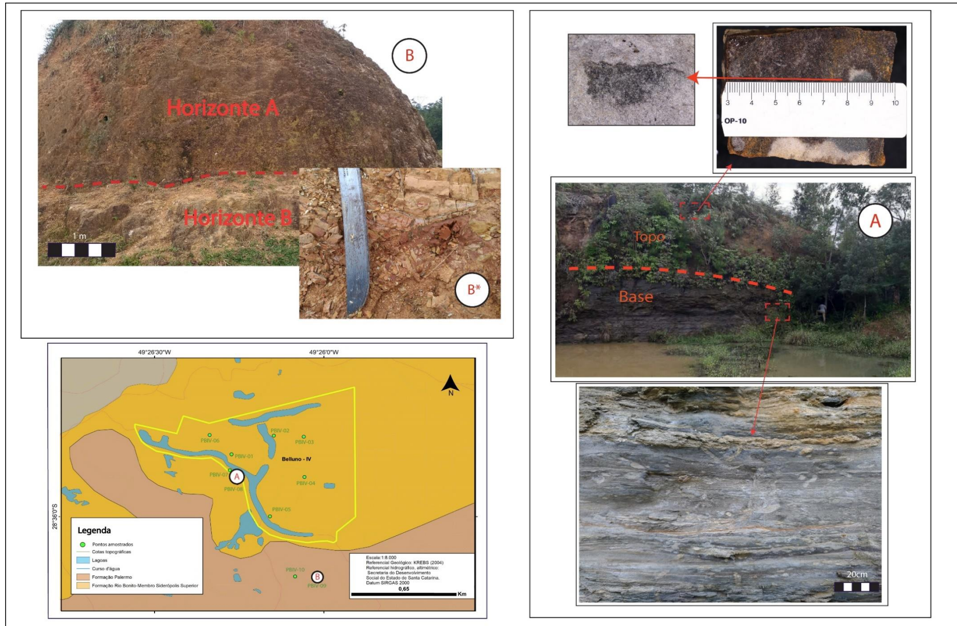
Figura 11: Mapa de pontos amostrados, com destaque para os pontos PBIV – 08 e 09, marcados por A) e B). Em A), foto do afloramento da Formação Rio Bonito dentro da área, dividida nas duas litologias aflorantes como litologia de topo e base, com fotos em detalhe apontadas na figura. Em B), afloramento da litologia da área de empréstimo do material, com os horizontes de solo A e B marcados na imagem. Em destaque, está B*), marcando em detalhe a rocha no horizonte B, o siltito arenoso com lentes de argila vermelha.
