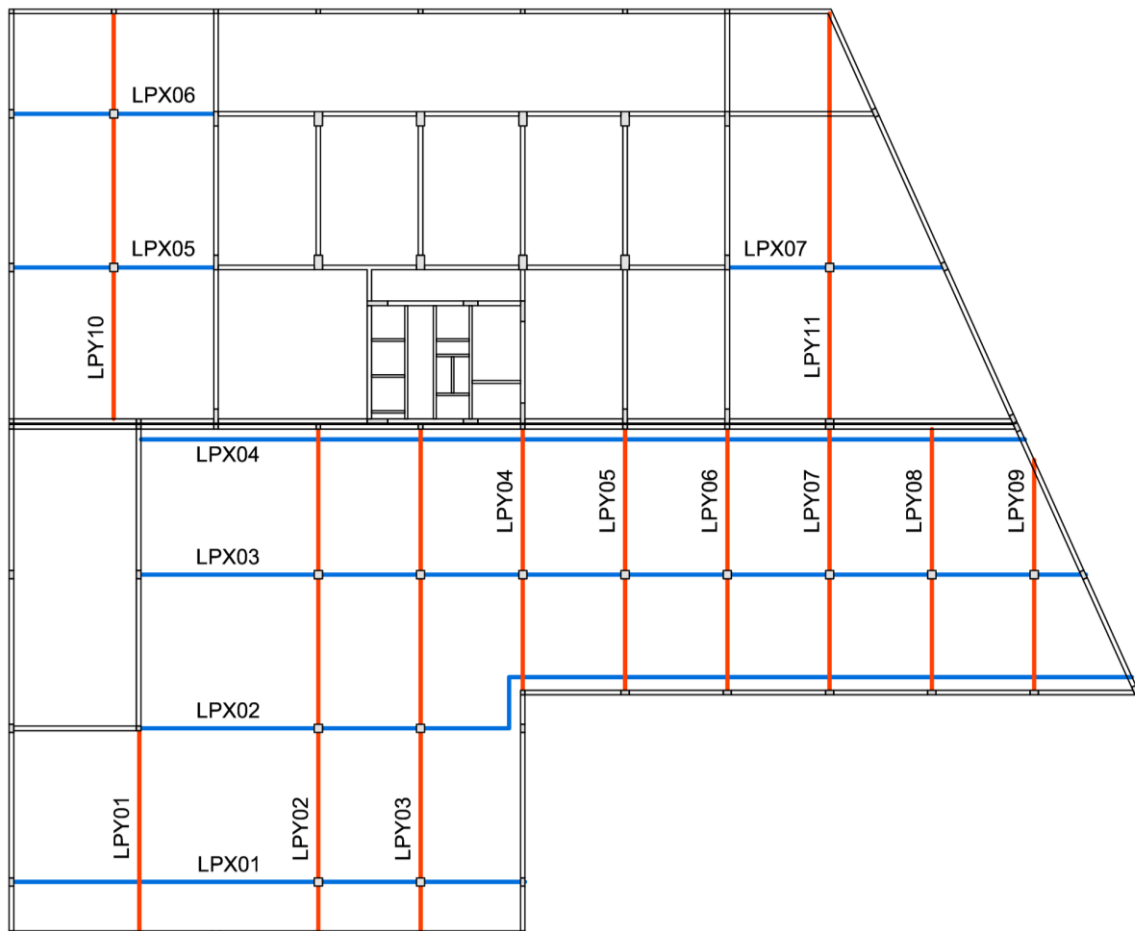
Figura 31 – Linhas de momentos utilizadas para o dimensionamento das lajes lisas.
