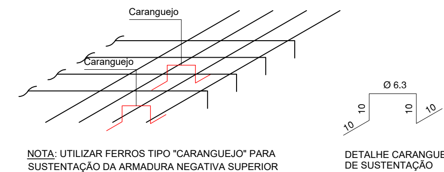
DETALHE DE FERROS TIPO CARANGUEJO
