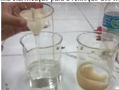
Figura 4: Filtração do sistema clarificação para a remoção dos flocos sedimentados.
