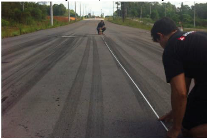
Figura 1: Medição da distância da frenagem
