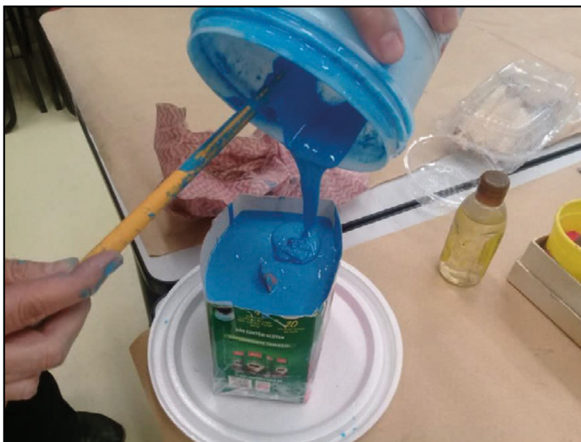
Figura 4: confecção do molde com borracha de silicone.
