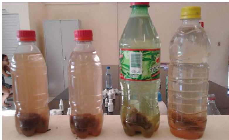
Figura 3 - Sistemas montados com garrafas de PET, palha de aço e amostras de água para determinação de OD nas amostras
