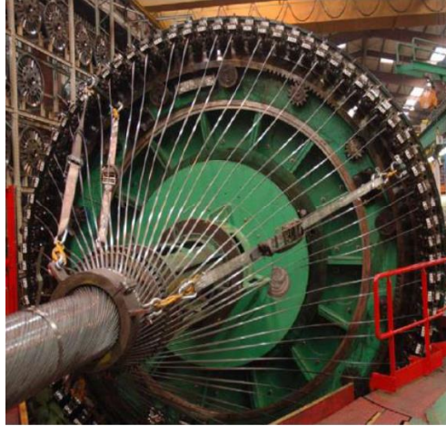
Figura H1 – Montagem de armadura de tração por armatriz. Fonte: 4SUBSEA (2013).
