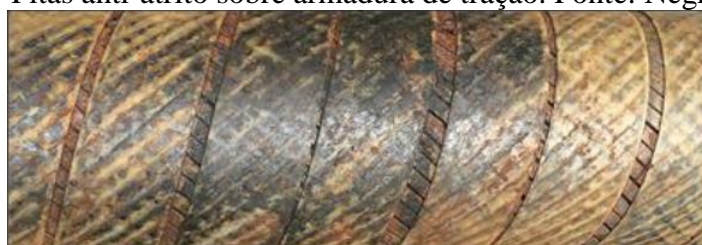
Figura G1 – Fitas anti-atrio sobre armadura de tração. Fonte: Negreiros (2016).
