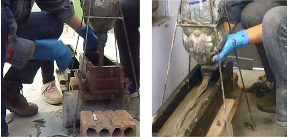
Figura 34: Vaciado de las mini-vigas.
