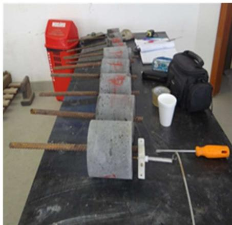
Figura 58: Cuerpos de prueba para el Pull-Out Test.
