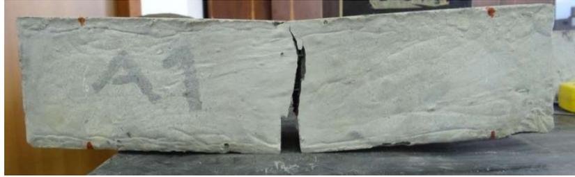
Figura 38: Falla en mini viga con 1% de fibras largas de acero.
