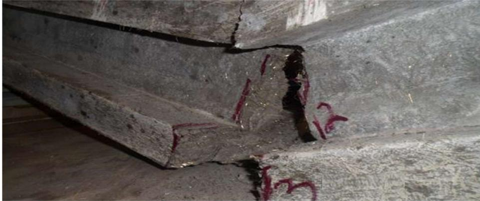
Figura 47: Colapso de Viga I con UHPFRC y microfibras de acero.
