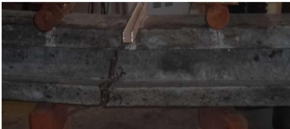
Figura 46: Tipo de falla. Viga I con microfibras.
