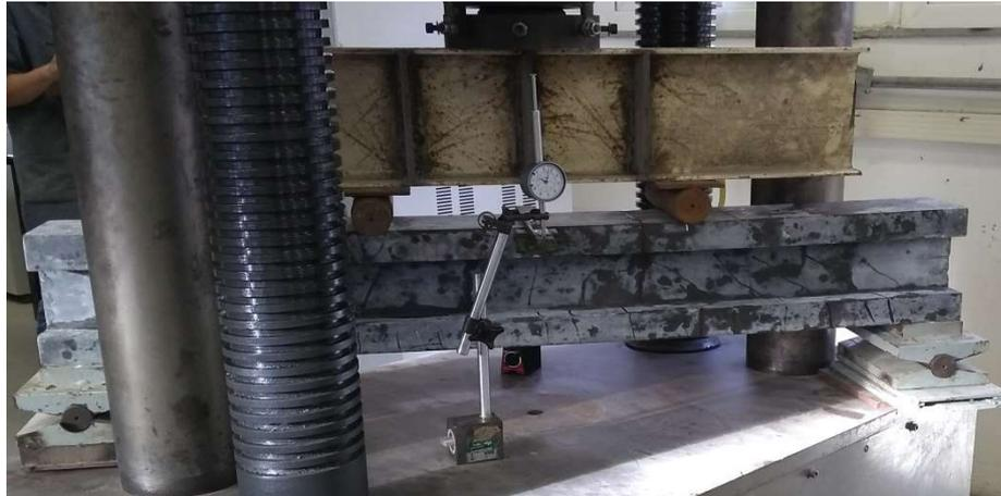
Figura 44: Viga I. Ejecución del ensayo de flexión.
