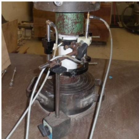
Figura 27: Medición post- agrietamiento en ensayo de compresión uniaxial.
