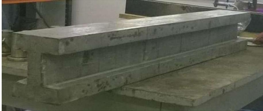
Figura 42: Viga I construida con UHPFRC.
