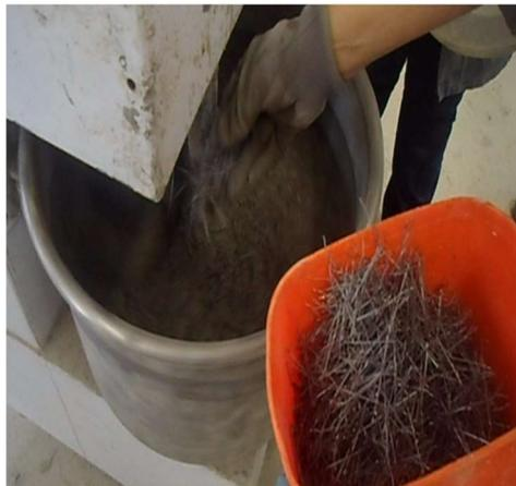
Figura 24: Adición de las fibras de acero a la mezcla.
