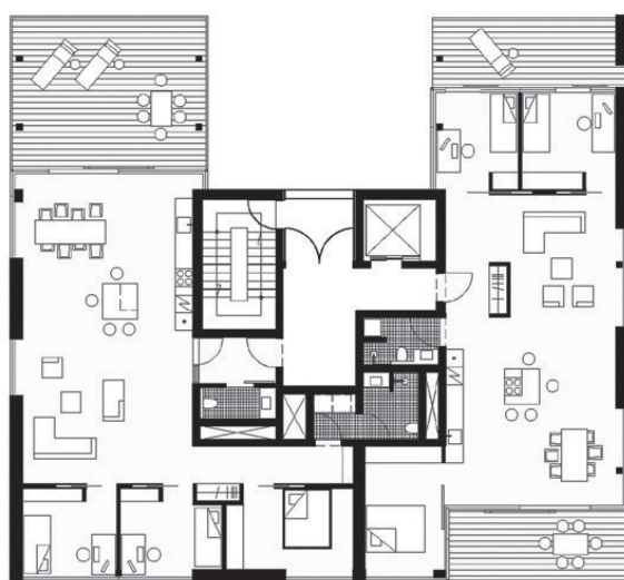
Figura 67 Siloetten - Planta baixa de um dos pavimentos com circulações verticais e corredores implantados no volume original central dos silos e volumes anexados envolvendo a construção silar.
