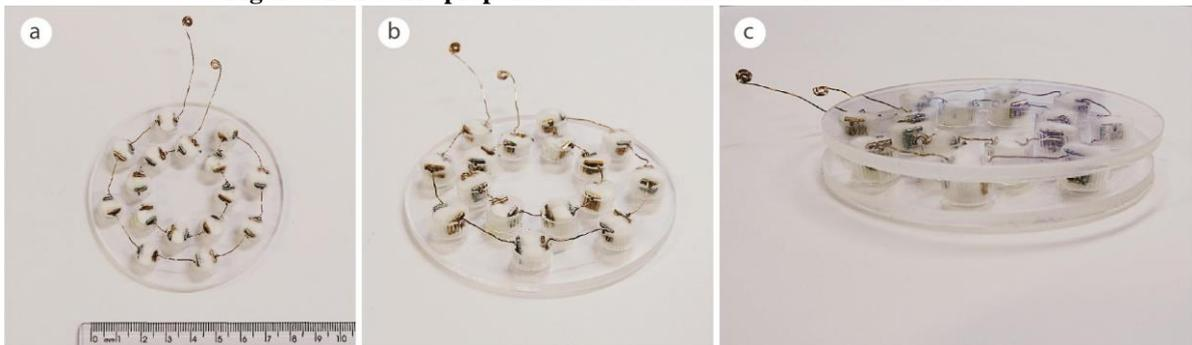
a) Bateria vista superior b) Bateria vista em perspectiva c) Bateria fechada.
