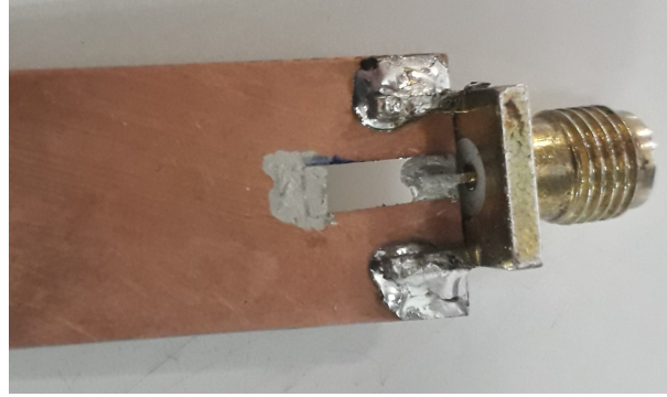
Figura 7 – Filme de CoZr utilizado como linha de transmissão terminada em curto para o método de magnetoimpedância.
