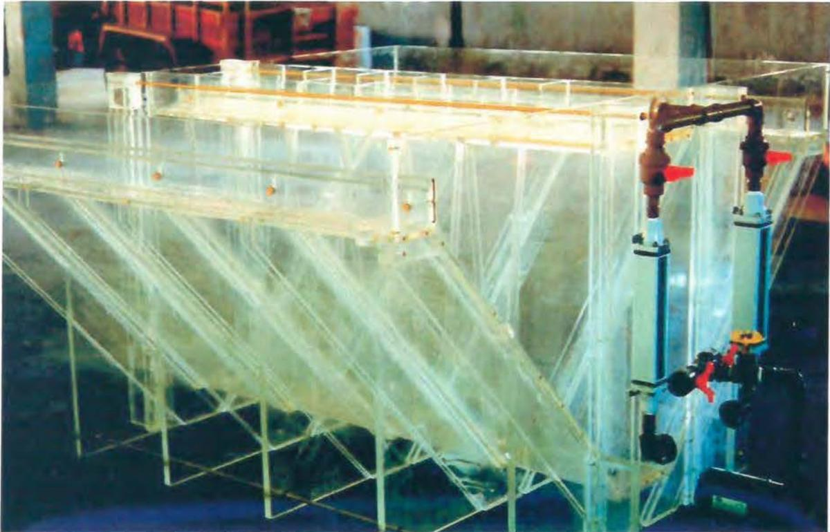
*Figura 3.6 – Modelo reduzido de um Digestor Anaeróbio de Fluxo Ascendente (Gimenez et al., 1998).*
