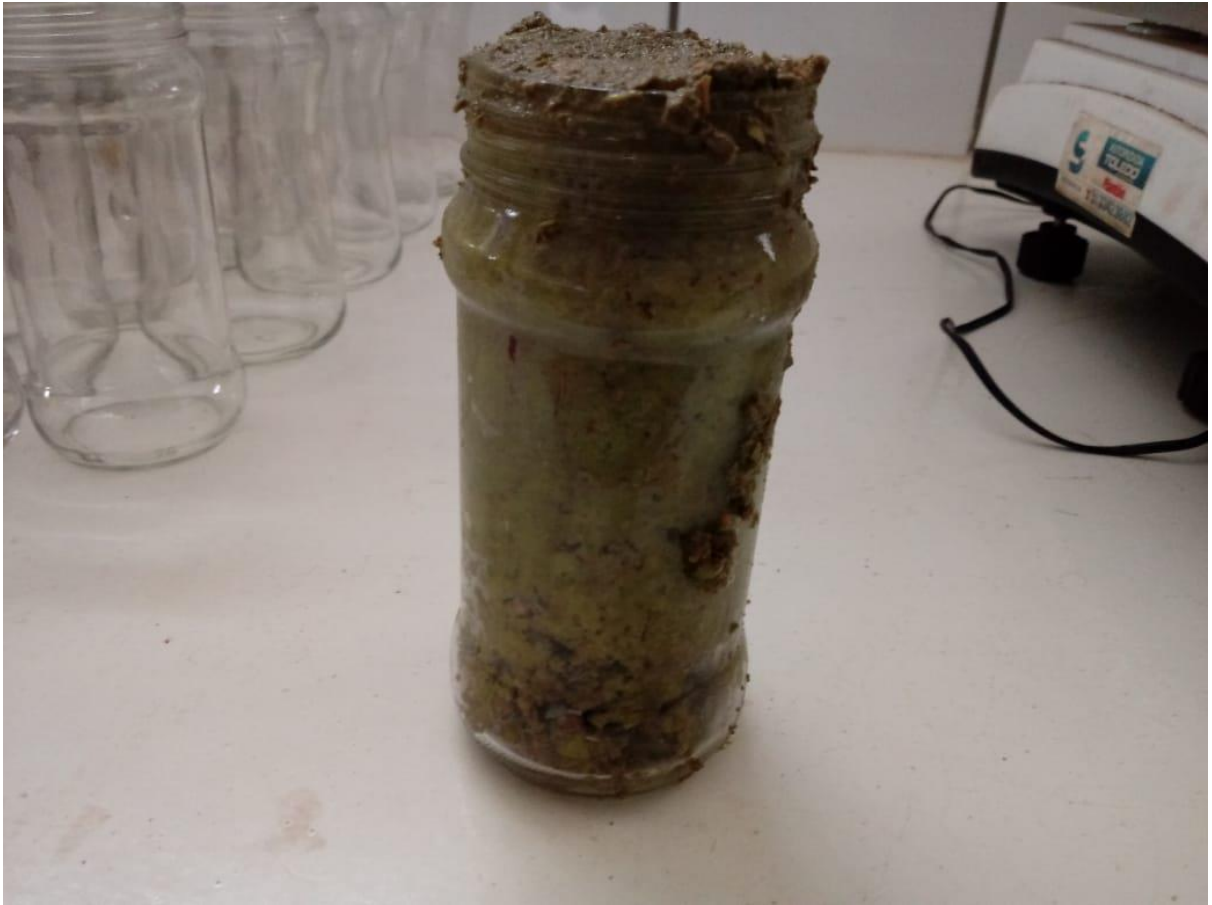
Figura 3 – Silo experimental de vidro com bagaço de azeitona.
