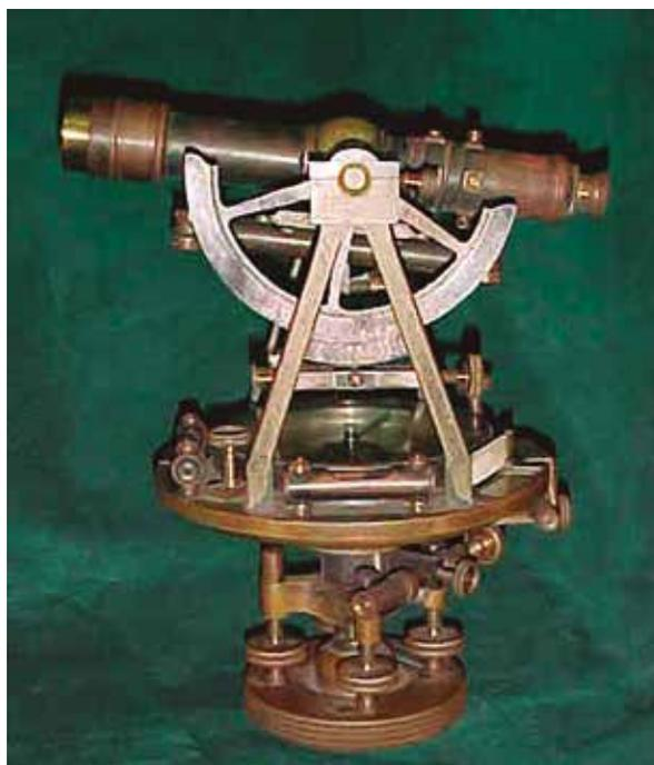
Figura 3: Teodolito-Trânsito de fabricação inglesa | Foto: Iran Corrêa
