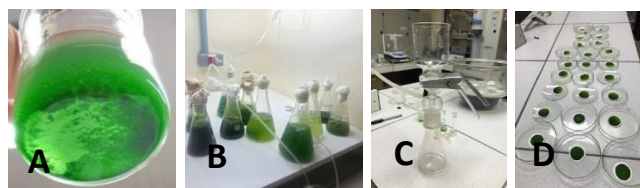
Figura 1: A) Microalga Scenedesmus sp. após o rompimento celular no ultrassom B) Cultivo das microalgas C) Aparelho utilizado para a filtração à vácuo das microalgas e D) Massa das microalgas retida nos filtros pós filtração.
