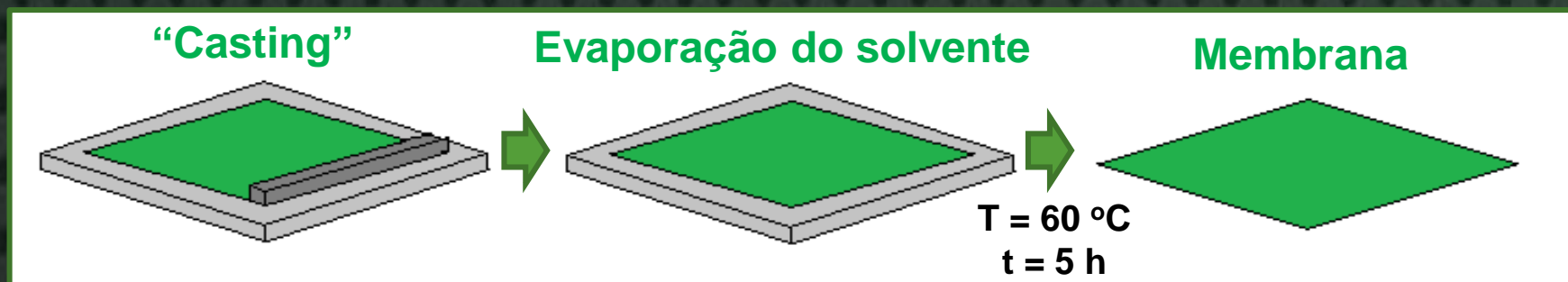
Figura 3: Esquema de fabricação de membrana por inversão de fases
