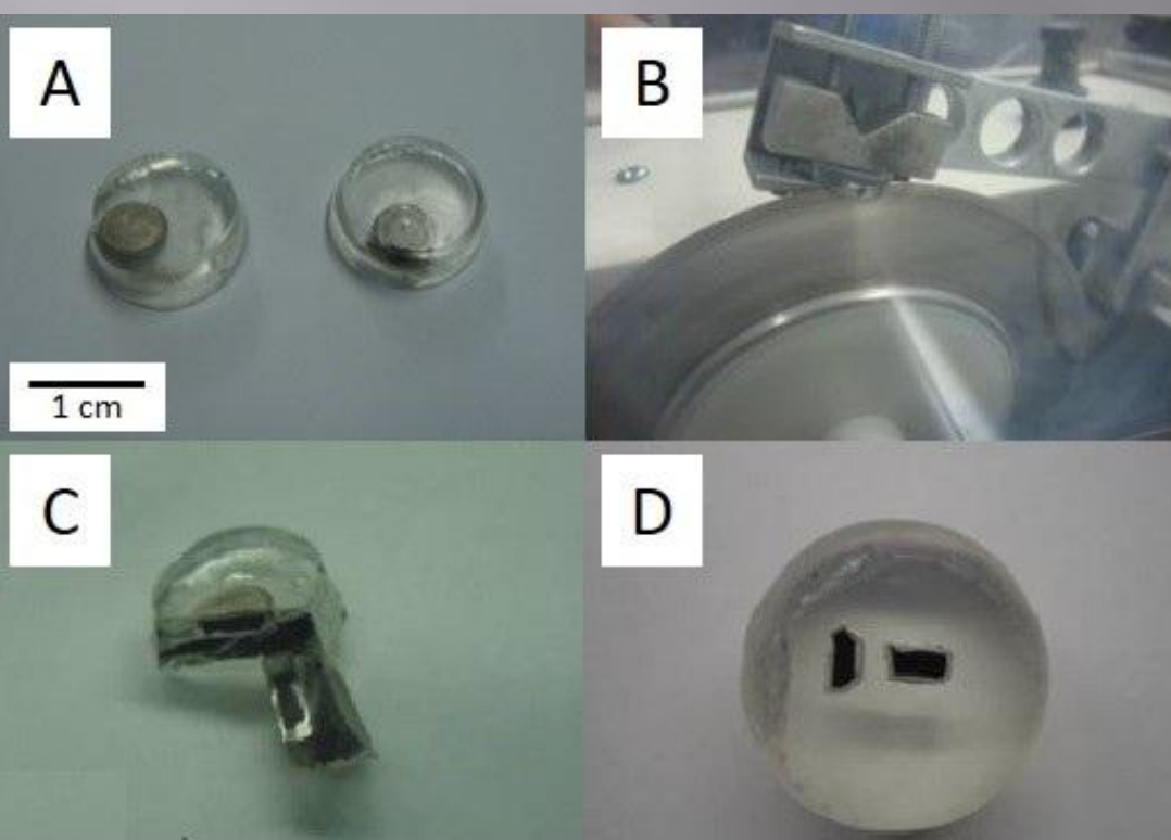
A- Cápsula pós processamento são colocadas em resina epóxi. B- Serra diamantada para corte da cápsula. C- Cápsula Cortada. D- Cápsula novamente colocada em epóxi com amostra exposta para polimento e análise.
