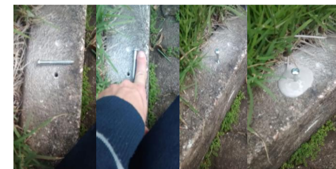
Fig 3: Sequência de teste de ancoragem utilizando adesivo epóxi
