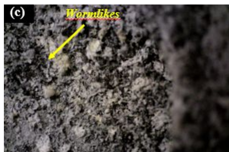
Figura 3. Micrografia do topo da camada carbonosa da placa revestida com a formulação E75B25.
