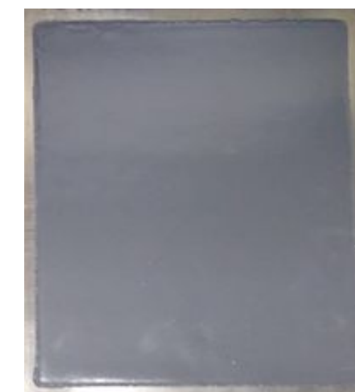
Tinta intumescente aplicada na placa de aço expostas por 7 dias ao ar para secagem total
