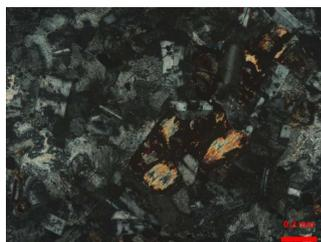
Fig. 7 – Alteração de magnetita para hematita e argilominerais.
