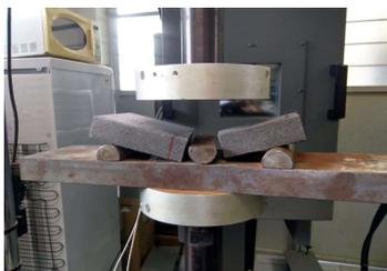
Fig. 3 – Corpo de prova rompido sob prensa após ensaio de flexão.
