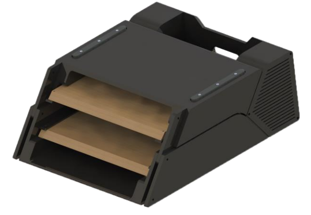
Figura 7: Parte estrutural dobrada (módulo 1 e módulo 2).
