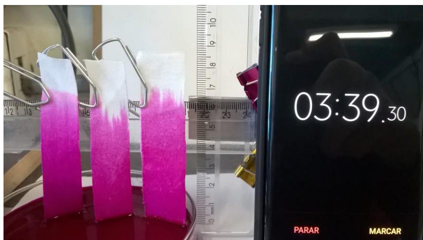
Figura 12 - Wicking test , teste para verificar a molhabilidade dos tecidos.
