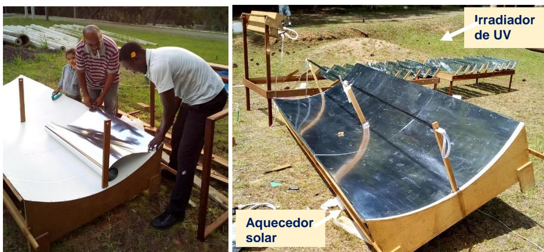
Figura 11: Sistema de desinfecção solar de água em fluxo contínuo.
