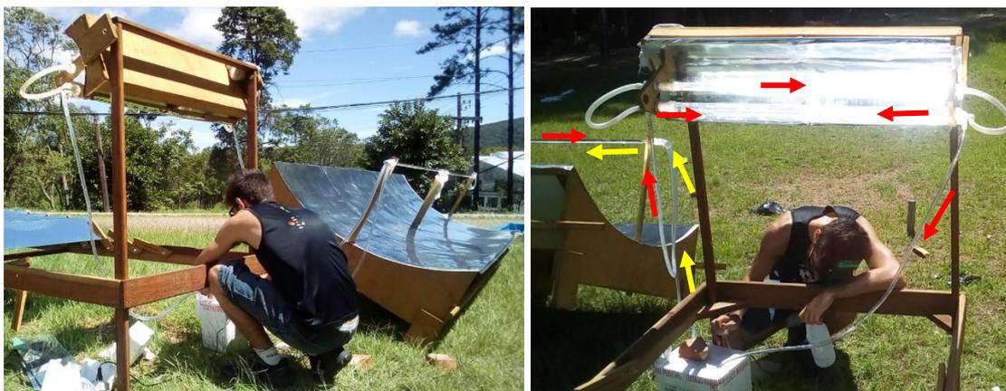
Figura 14: Sistema de SODIS de água em fluxo contínuo em funcionamento.
