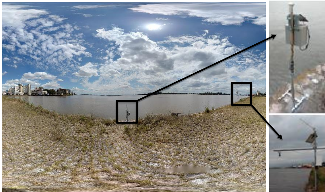
Figura 29 - Localização do sensor próximo ao linígrafo. Estação refletométrica (direita-acima) e Linígrafo (direita-abaxo)
