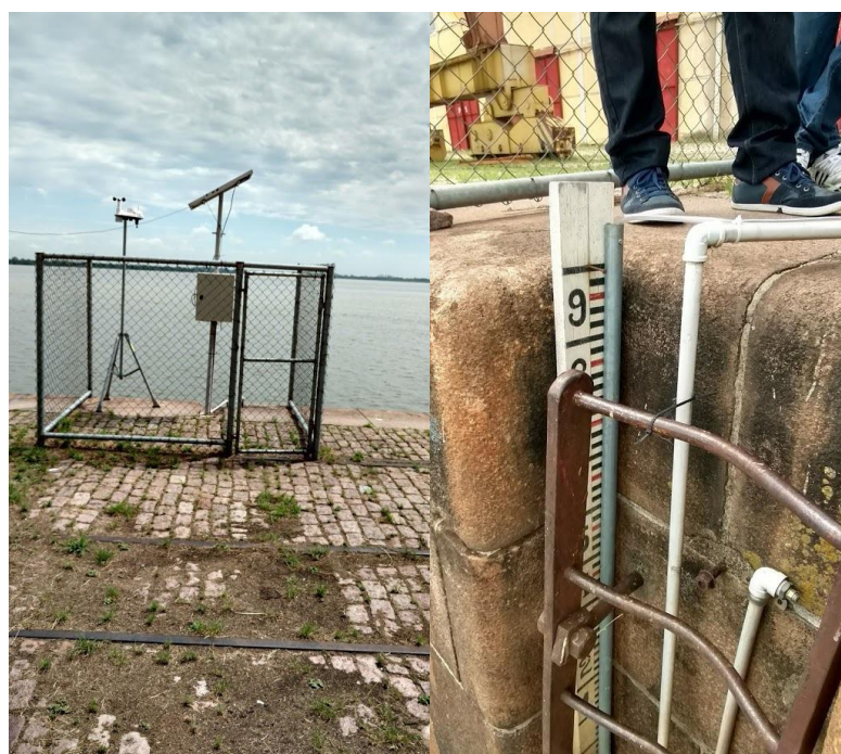
Figura 32 - Régua com sensor de pressão localizada no Cais Mauá
