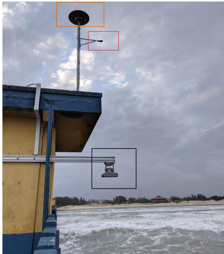
Figura 62 - Sensor GNSS-R fixo em Balneário Rincão
