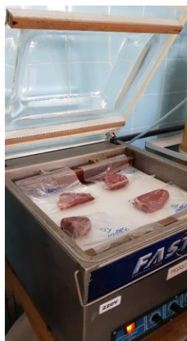
Figura 1: Pedacos de filé mignon sendo submetidos ao processo de retirada do ar dos sacos plásticos pela seladora a vácuo.
