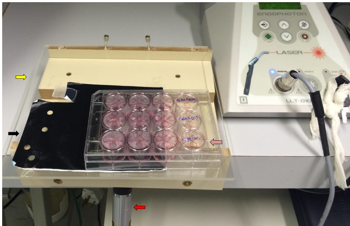
Figura 2. Placa de cultivo sobre o template (⇒) . Acima da placa de cultivo observa-se o grid (⇐) para padronização das irradiações. A caneta do aparelho (⇐) permanece imóvel e posicionada abaixo da placa de cultura. O campo semi-escuro (⇨) delimita a área de irradiação, minimizando a reflexão da luz.
