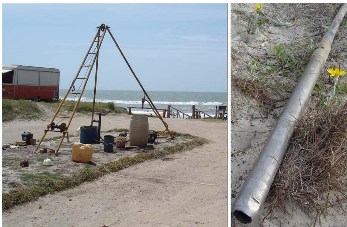
(Figura 7) Sondagem FS-29 acima da escarpa do pós-praia e a direita o amostrador RAYMOND/TERZAGHI.
