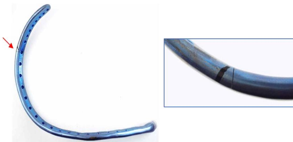
Figura 30 - Amostra 2, A esquerda vista do componente mandibular com seta para a trinca e a direita, ampliação da imagem da trinca
