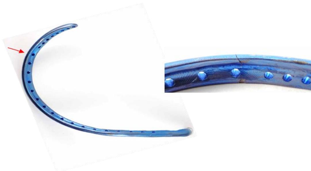
Figura 33 - Amostra 5, A esquerda vista do componente mandibular com seta para a trinca e a direita, ampliação da imagem da trinca
