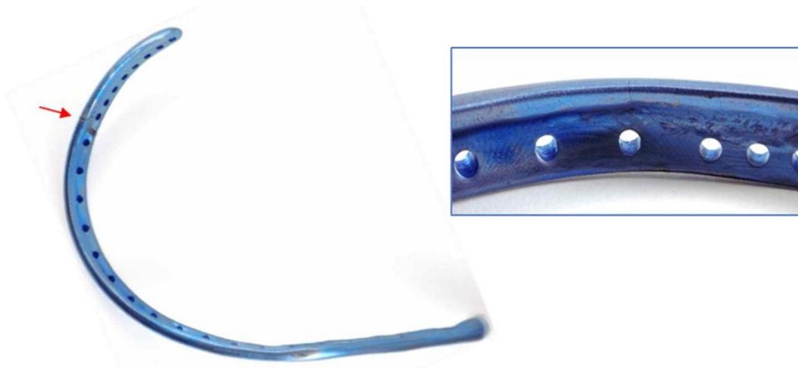
Figura 29 - Amostra 1, A esquerda vista do componente mandibular com seta para a trinca e a direita, ampliação da imagem da trinca
