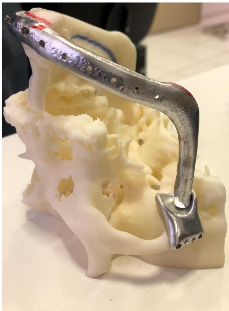
Figura 24 – Biomodelo do paciente sendo utilizado para testar o encaixe com a prótese usinada
